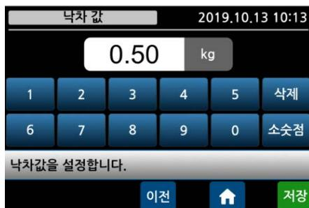
High Limit 모드, Low Limit 모드, 리미트 모드의 상한낙차값을 설정합니다.
