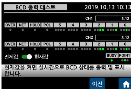
현재값의 BCD 출력 상태를 화면에 표시하거나, 전체 출력 값을 ON/OFF 할 수 있습니다. 채널별 출력 모드에서는 62 PIN 을 모두 사용하고 합산출력모드에서는 채널 1 번에서만 동작합니다. (BCD 출력 PIN 1~29 번, 58~ 61 번만 동작)
