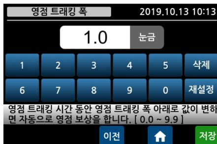
영점 트래킹 시간과 트래킹 폭을 사용하여 적정 값을 입력하십시오. 측정 값의 영점 드리프트를 검출하여 자동으로 영점 보정되는 눈금 폭을 선택합니다.
