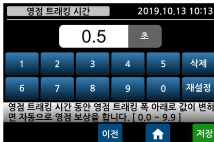
미세한 먼지가 쌓여 영점이 변화하거나 센서의 부하를 완전히 제거하였는데도 불구하고 0 점으로 복귀하지 않을 때 자동으로 0 점을 잡기 위한 기능입니다. 영점 트래킹 시간과 트래킹 폭을 사용하여 적정 값을 입력하십시오.
