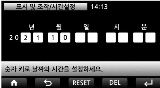
화면 상단에 표시되는 시간을 설정합니다. 주위 온도 및 주변 환경에 따라 시간 오차가 발생할 수 있으므로 한 달에 한 번 시간 재설정을 권장합니다.
