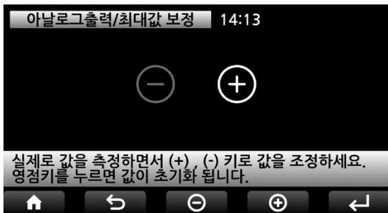
아날로그 출력의 최대값을 조정합니다. 5V, 10V, 20mA, 24mA의 값을 조정할 수 있습니다. 멀티 미터를 아날로그 출력에 연결하고 +, -버튼을 사용하여 실시간으로 최대값을 보정합니다. 값을 빠르게 변경하려면 +, -버튼을 길게 누르십시오.
