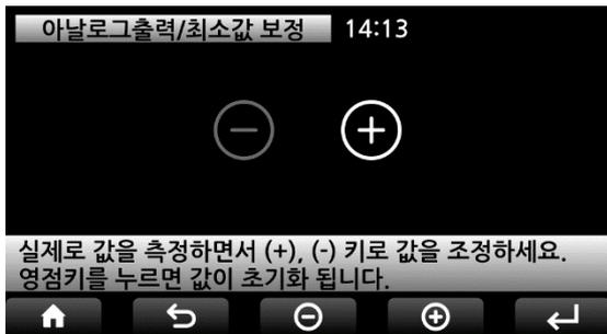
아날로그 출력의 최소값을 조정합니다. 0V, -5V, -10V, 0mA 및 4mA의 값을 조정할 수 있습니다. 멀티 미터를 아날로그 출력에 연결하고 +, -버튼을 사용하여 실시간으로 최소값을 보정합니다. 값을 빠르게 변경하려면 +, -버튼을 길게 누르십시오.
