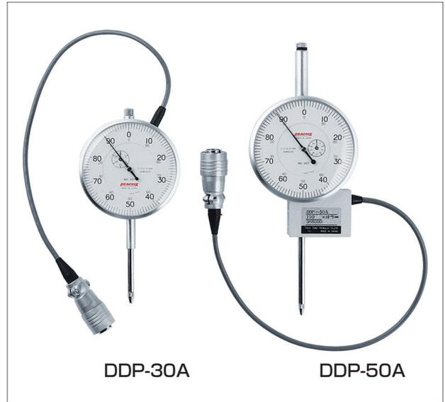
다이얼 게이지에 기외부, 브릿지 회로를 내장한 변위계입니다. 다이얼 게이지의 지침으로 직접 변위량을 목시하면서, 변형 게이지 출력으로 기록이나 기계의 제어 등이 가능합니다.
