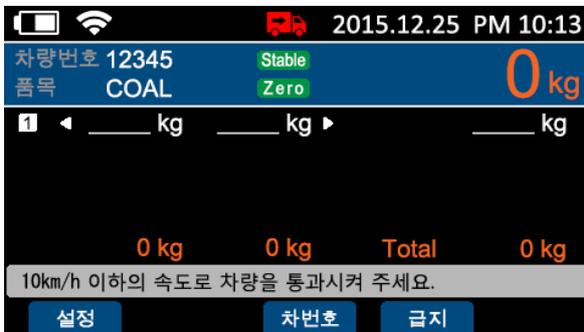
❶ 화면 상단에 무 정지 계량 아이콘을 확인하십시오. 만약 무 정지 계량이 아닌 경우에는 [설정]키를 누르고 측정 메뉴에서 계량 방식을 변경 해야 합니다.
