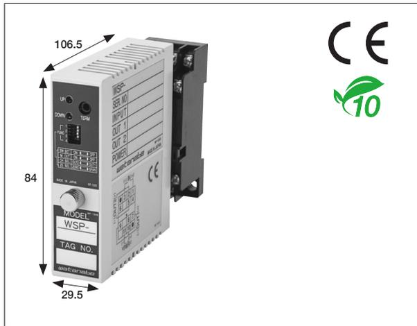
本 기기는 3 선식 전위 값에서 추출되는 회전 각도와 직선 이 동량 등을 직류 전류 또는 직류 전압으로 변환하는 소형 플러그인 방식의 변환기입니다. CPU를 탑재 한 디지털 형으로 전용 설정 도구에서 입력 범위, 출력 범위, 각종 파라미터 변경 및 모니터링, 모의 입출력을 현장에서 할 수 있습니다. 리니어 라이저 센서 단선 경보하는 번 아웃 회로를 장비하고 있습니다.
