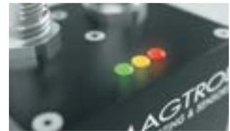
이 색상 코드는 측정 상태, 용기 기능, 오프셋 값, B.I.T.E.와 같은 센서의 작동 상태를 지속적으로 전달합니다. (내장 테스트 장비) 및 과부하.
