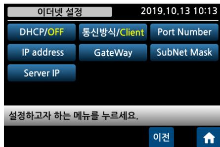
ModeBus-TCP 프로토콜을 이용하며, 평선 코드 및 맵은 ModeBus-RTU 와 동일합니다.
