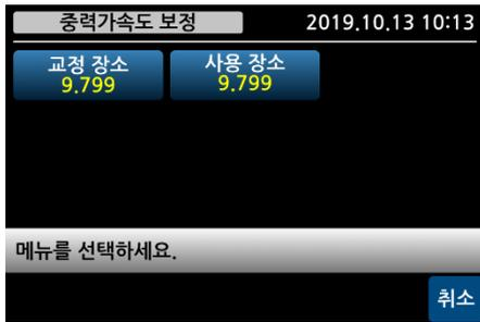
ACJ의 교정된 값을 중력보상하는 메뉴입니다. 실 부하 교정 장소와 중력 가속도 값이 다른 타 국가 및 지역에서 사용할 경우, 사용 장소의 중력 가속도 값을 입력하여 측정 값 보정을 하는 모드로 해당 사항이 없으면 사용하지 않습니다.
