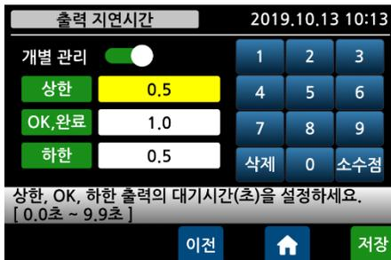
출력 지연시간 이후에 해당 외부 출력이 ON 됩니다. 단, 리미트 모드, 리미트 타입 체커 모드에서는 동작하지 않으며, 개별 관리를 ON 하면 OK 및 하한 출력 지연 시간을 각각 입력할 수 있습니다.
