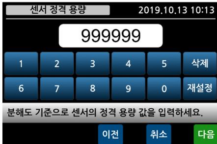
센서 성적서에 기재된 센서의 정격 용량(R.C.: Rated Capacity)을 입력하십시오.
