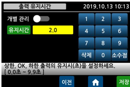
외부 출력이 ON 되고, 출력 유지시간 이후에 해당 외부 출력이 OFF 됩니다. 단, 리미트 모드, 리미트 타입 체커 모드에서는 동작하지 않으며, 개별 관리를 ON 하면 OK 및 하한 출력 유지 시간을 각각 입력할 수 있습니다.
