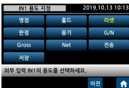
외부 INPUT1 ~INPUT4 접점의 용도를 설정합니다. 전송은 외부 통신기기(프린터, PC 등)으로 DATA 를 전송합니다. 저장은 SD Memory Card 에 DATA 를 저장합니다.
