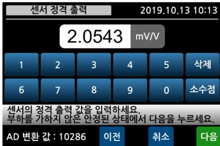
센서 성적서의 정격 출력 값(R.O.: Rated Output)을 입력하십시오. 참고로, 알루미늄 재질의 로드셀은 성적서의 출력 값이 실제 출력 값과 다를 수 있으니 반드시 고 정밀 DVM 으로 실제 출력 값을 측정하여 입력하십시오. [다음] 키를 누를 때 영점 교정이 동시에 이뤄지므로 반드시 무 부하 상태에서 진행하십시오.
